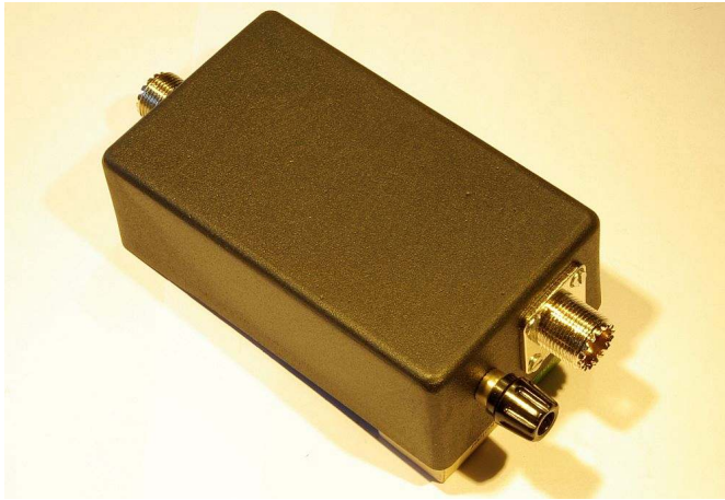
Mantelströmdrossel inbyggd i plastlåda
