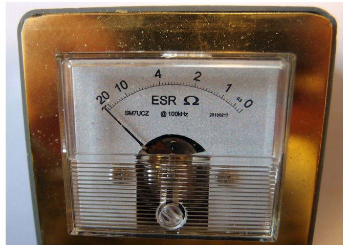
Med detta enkla ESR-instrument letas sjuka elektrolyter snabbt upp i trilsande apparater.
