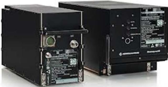
Bild 3. Radioenhet och antenncanpassare enligt ARINC 719 (Rohde&Schwarz XK 516D, med inbyggt modem för ARINC 753 HF-datalänk)
