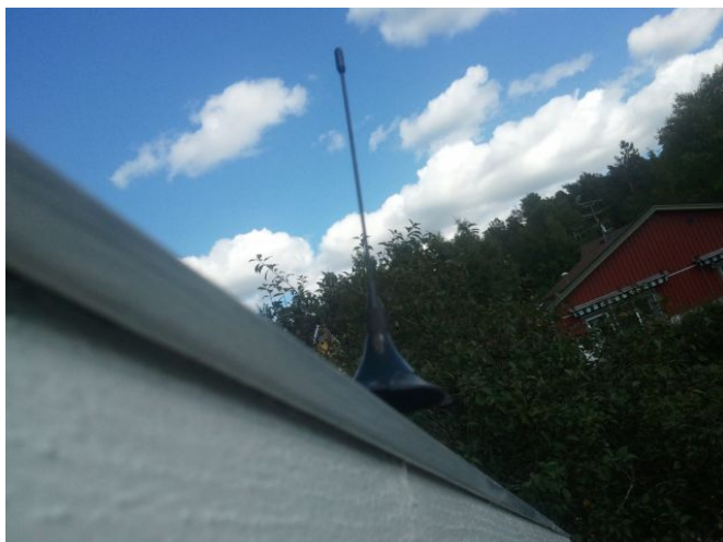
Bild 4: Enkel RTL-SDR antenn på taket
