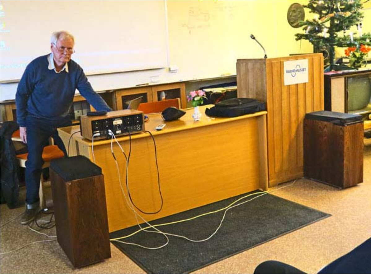
Toorleif Jonsson rattar sin Revoxförstärkare på 2X40 W ansluten till två Carlssonhögtalare OA5 typ 2.
