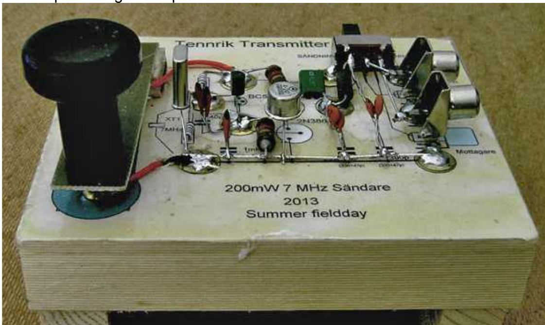
Sändaren på 200 mW för telegrafi på 7 MHz.
