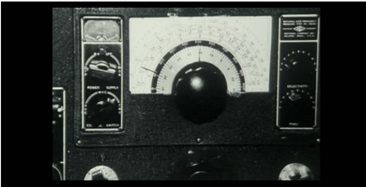
National NC100X, mottagaren som användes av den finska signalspaningen.
